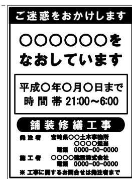
工事名等を記載した標示板
